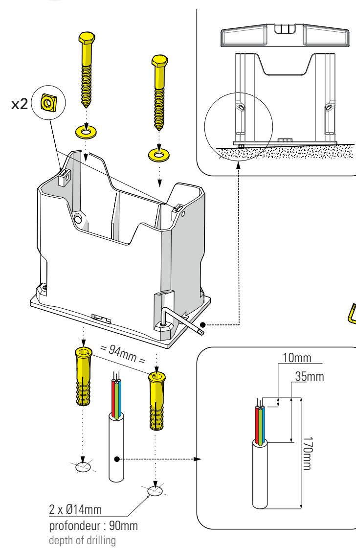
**3** Fixation de la borne & raccordement électrique
